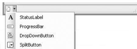
Cliquez sur la barre d'état (pour la sélectionner), puis sur la flèche vers le bas dans la première icône pour créer, dans la barre d'état, des étiquettes (StatusLabel, qui peut être une zone d'affichage, une image ou un lien), une barre de progression (ProgressBar) ou un bouton (DropDownButton ou SplitButton). Pensez à donner des noms significatifs aux noms internes (propriété Name).
