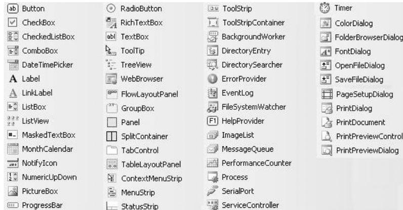
Ces composants sont amenés dans la fenêtre de développement de manière aussi simple qu'intuitive (voir la section 14.3), par un glisser-coller à partir de la boîte à outils jusqu'à la fenêtre de développement.
